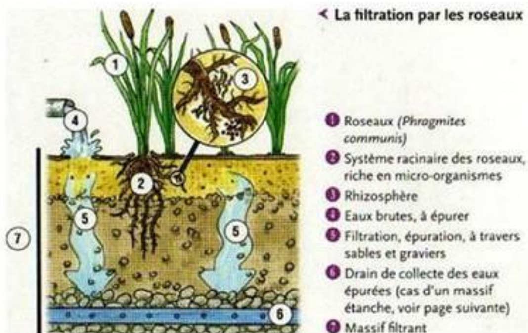
Principe de la filtration par roseaux
